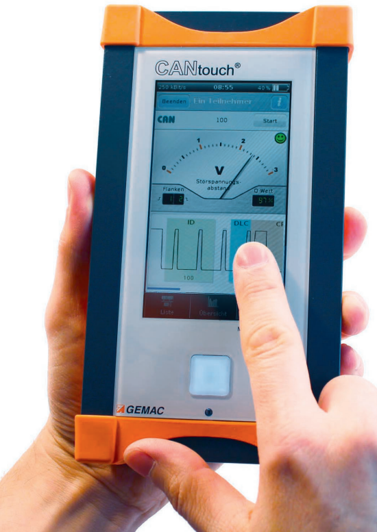
Bild 1: Feldbusdiagnosesystem CANtouch. © Gemac
